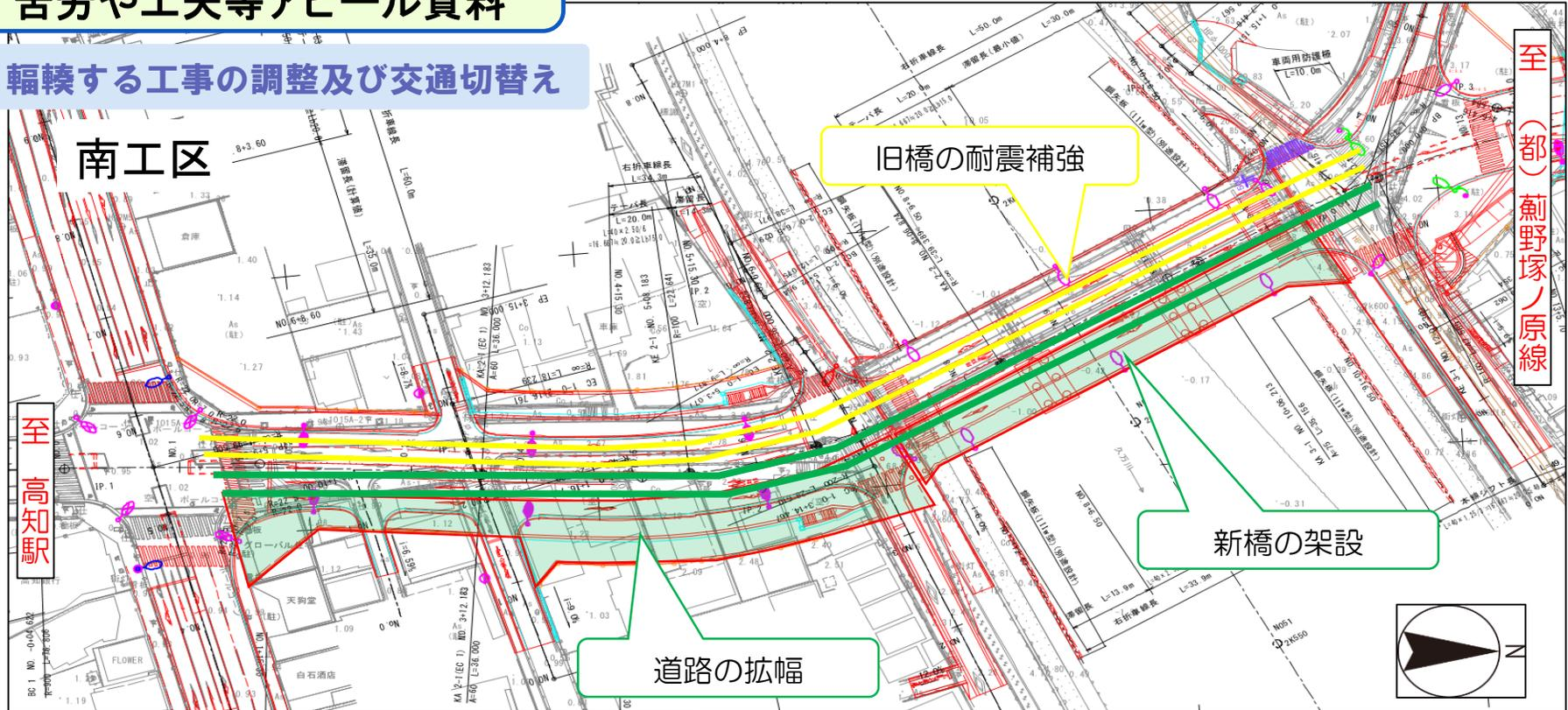
○南工区は歩行者・自転車の交通量が極めて多く、三次救急医療機関への緊急車両が頻繁に通行することから通行規制は実質的に不可能であった。このような条件下において、工区全体の路面を嵩上げするとともに、狭隘な2車線道路を拡幅(緑ハッチ部)し、4車線+両側歩道を整備した。施工時期によっては、最大5者が工区内の工事を進めており、工程調整会議を定期的で開催し、発注者の案を各事業者の目線で確認し、問題点の洗い出しや各工程のすり合わせを実施するなど、事業全体の工程管理を行い事業を進めた。
