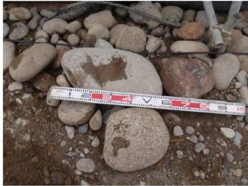
周辺の土質は、玉石の混在率が高く、直径60cmの玉石も確認されたため、鋼矢板打ち込み時の工事騒音が問題となった。
