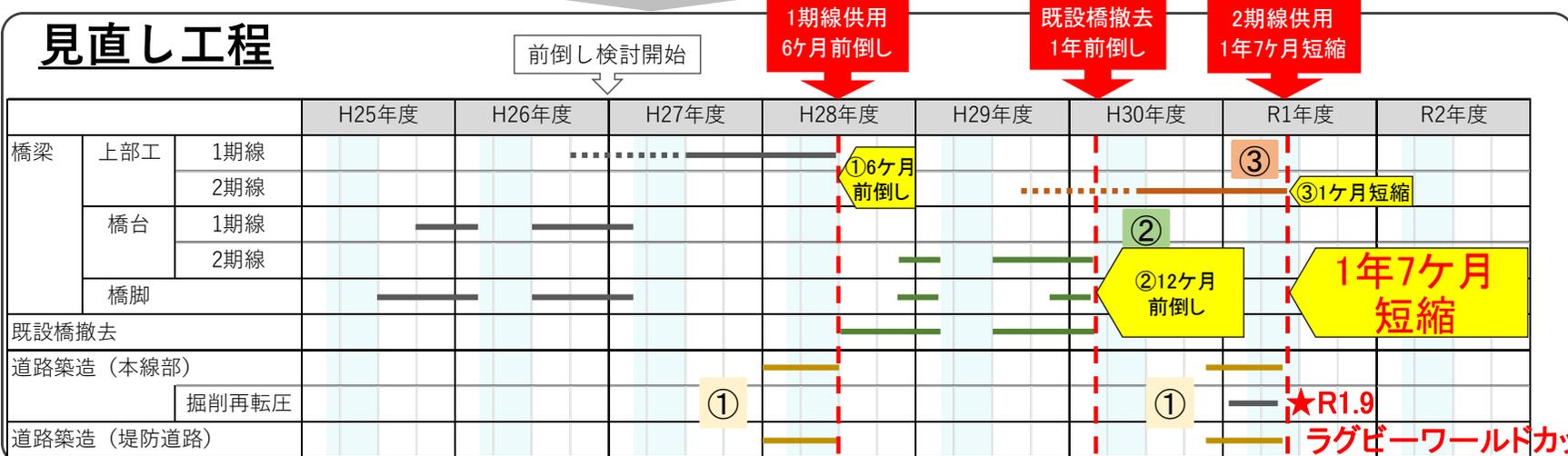
①1期線上部工架設と両岸取り付け道路、堤防道路の同時施工により効率化を図り、1期線供用と既設橋撤去着工を6ヶ月前倒し
