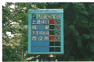
各駐車場の満空・ルート案内
