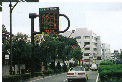
駐車場案内システム
