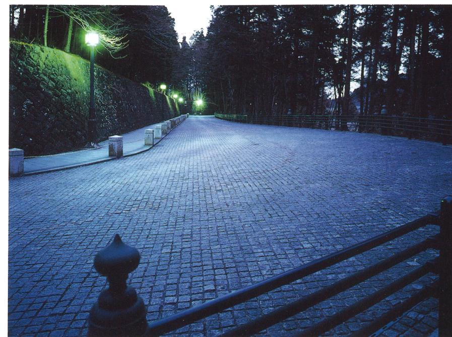
ミカゲ石のピンコロ舗装とし、冬季の凍結によるスリップ防止も兼ねた。歩車道分離にミカゲ石柱と鉄鎖使用。
