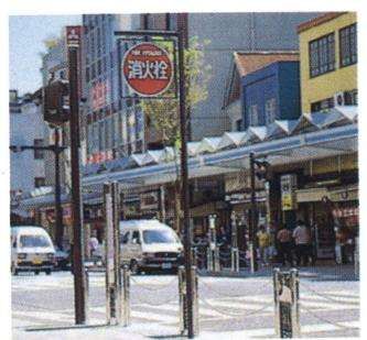
消火栓標識柱／通りのイメージを損うことのないよう標識板のみを赤にしている。
