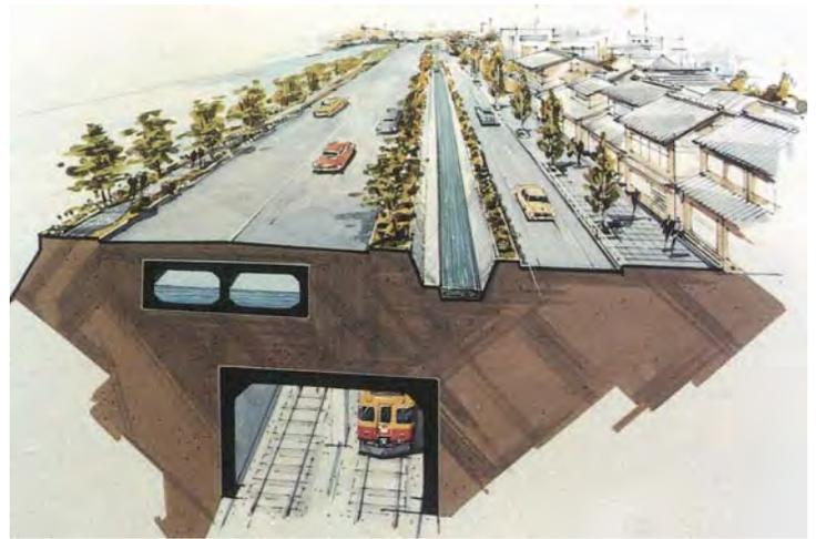
用地の高度利用を図るため、京阪本線、琵琶湖疏水、鴨川東岸線の3層構造を採用
